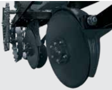
Disco duplo no adubo e na semente. Double disc in the fertilizer and the seed. Disco doble en el abono y en la semilla.
