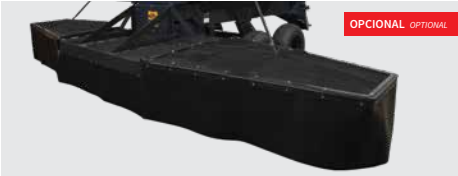
Defletor de borracha para a distribuição de produtos em pó, garantindo maior uniformidade na distribuição. Rubber deflector for distribution of powder products, ensuring more uniform distribution. Deflector de goma para la distribución de productos en polvo, asegurando una mayor uniformidad en la distribución.
