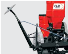
•Sistema de marcador de linha manual. Frontal row marker (mechanic). Sistema de marcador de líneas manual.
